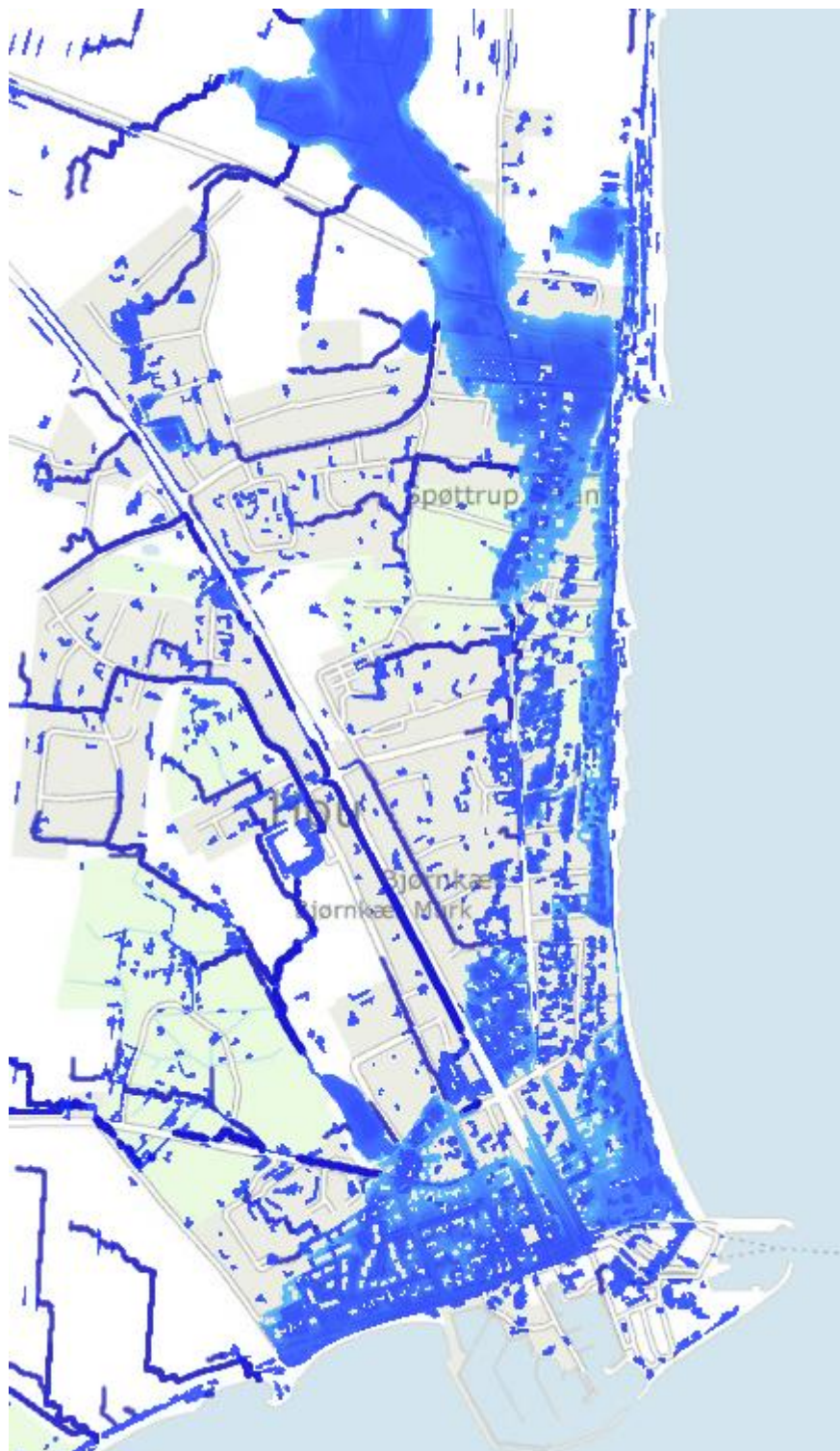
Figur 4.1: Oversvømmelser og strømningsveje ved etablering af højvandsbeskyttelse ved 50 mm regn. Figuren viser kun strømningsveje med et opland på minimum 1 ha
