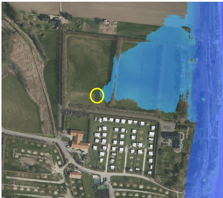
Figur 5.2: Placering af lavpunkt nord for campingplads, der skal sikres med beredskabsløsning, hvis diget ikke fortsættes nordpå til terrænet når 2,81 m.
